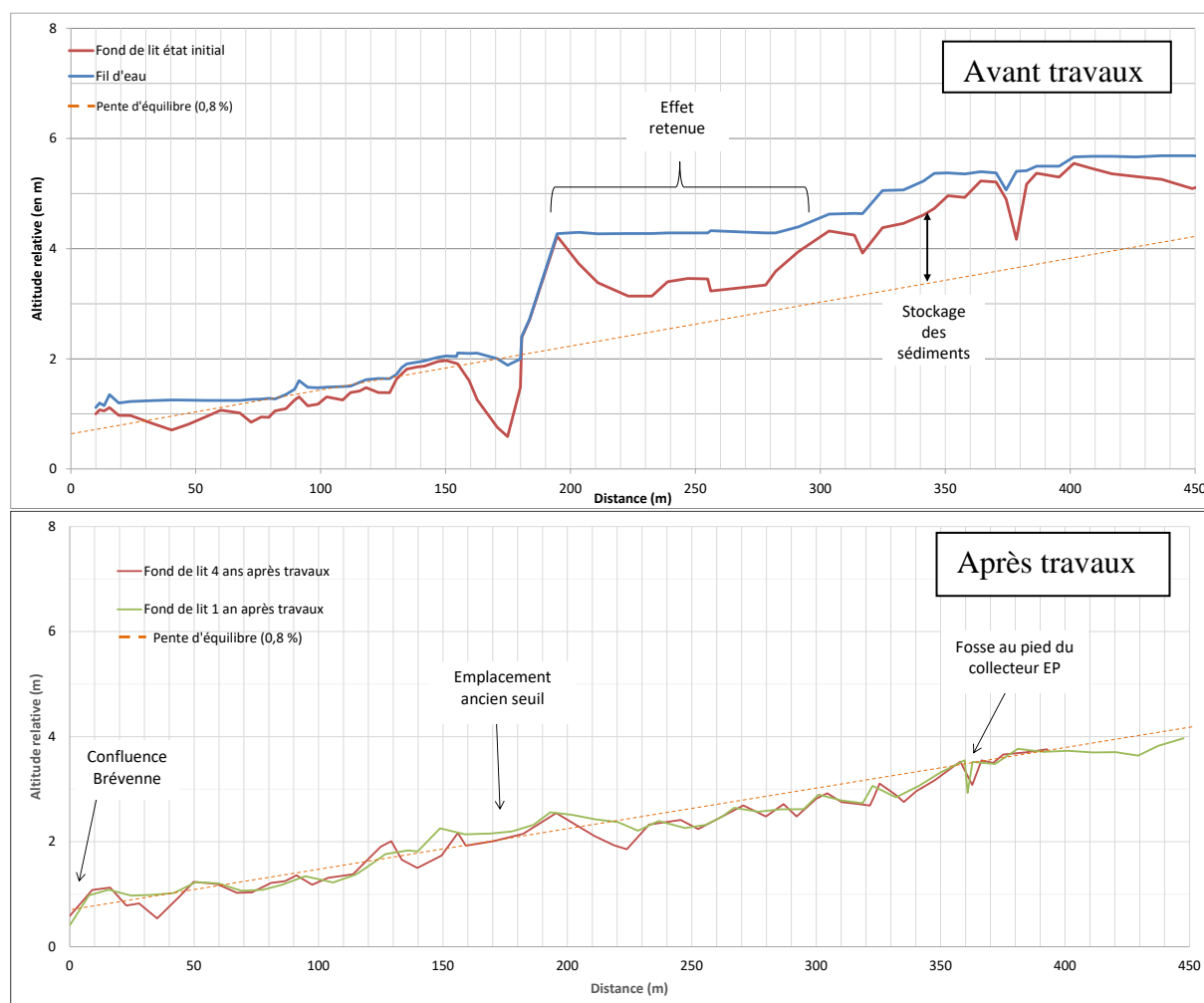
Figure 5: Profil en long avant travaux (2016) et après (2018 et 2021)
