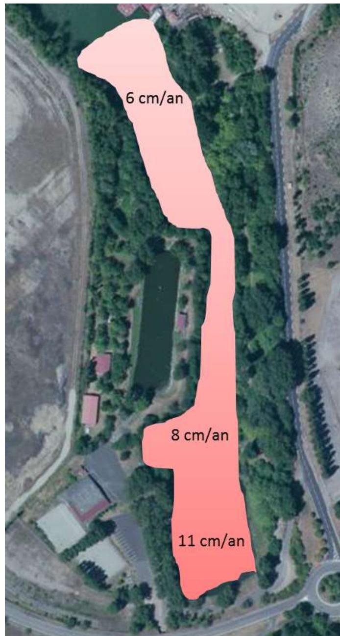
Figure 10 : Représentation graphique du comblement de la lône du Prin (Source : CNR)
