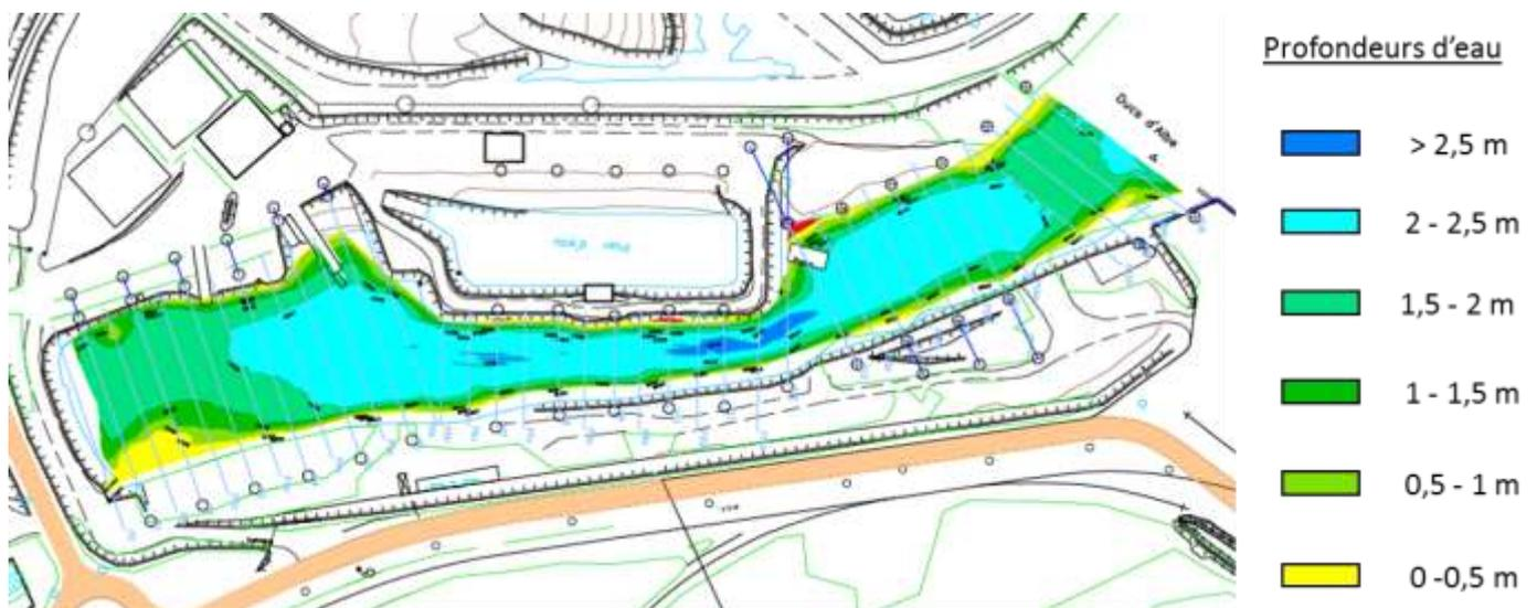
Figure 9 : Carte bathymétrique de la lône du Prin en 2015 (Source : CNR)
