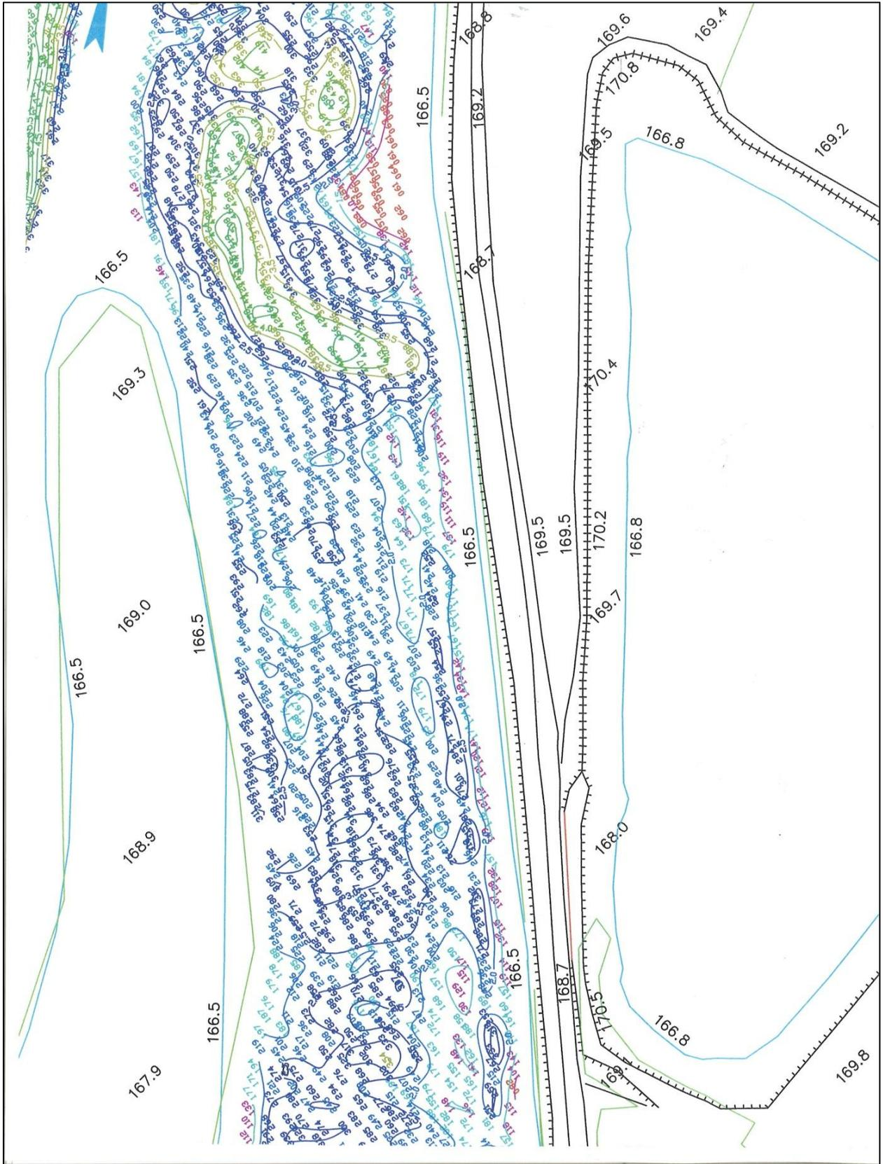
Figure 7: Bathymétrie du bras de la Saône au droit du plan d'eau de Chamalan (Source: VNF)
